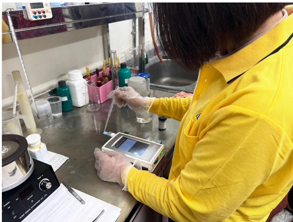
圖 12、C 工廠現場人員於放流口採樣後以晶片式電極檢測銅離子濃度
